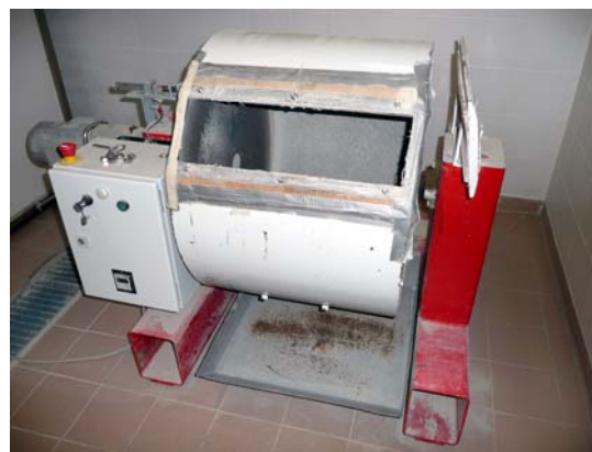
Figure 8 : Principe et appareillage de l'essai Los Angeles (Cete-SO – Laboratoire de Toulouse)
