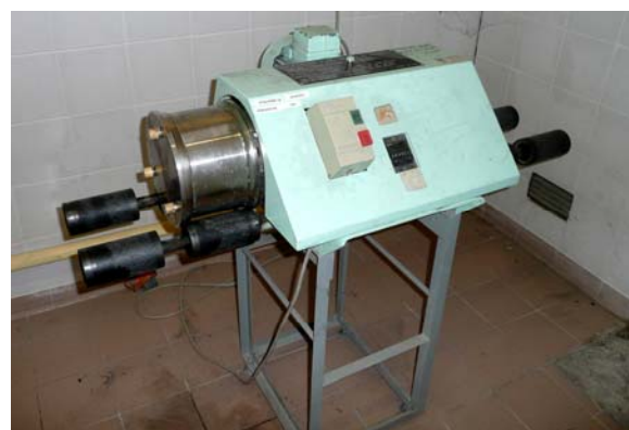
Figure 9 : Principe et appareillage de l'essai Micro-Deval (Cete SO – Laboratoire de Toulouse)
